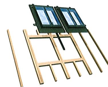
Jumelage de deux châssis.
